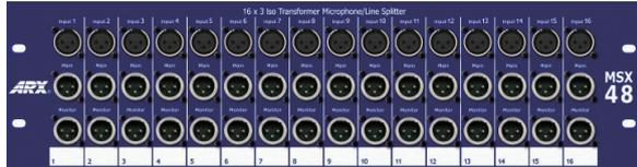
**16通道变压器平衡式分配器，1分3分配。**主电源分配经过幻像电源，加上一个监听分配和后面板Aux分配。后面有D-Sub连接器。这是一台完全的无源设备，无需AC电源。
